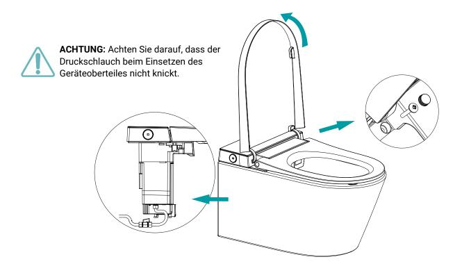
Schalten Sie den Strom ein, indem Sie die hintere Displayabdeckung des Dusch-WCs aufklappen und den Schalter "ON" betätigen. Das Dusch-WC initialisiert sich nun. Hierbei fährt der Duscharm einmal vollständig aus und wieder ein und der Tank befüllt sich vollständig. Wenn eine Temperatur im Display auf dem Dusch-WC angezeigt wird, war die Initialisierung erfolgreich. Fahren Sie nun mit der Installation der Fernbedienung fort.
