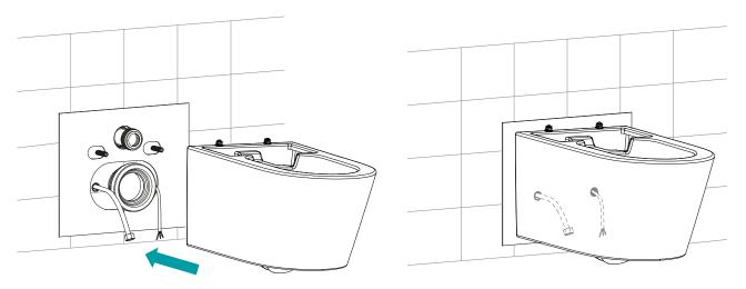
Richten Sie die Toilette mit Hilfe einer Wasserwaage aus und ziehen Sie diese anschließend mit max. 10 Nm fest. Dies entspricht etwa der Zugkraft, die Sie durch Ziehen des Schraubenschlüssels mit dem kleinen Finger erreichen können.
