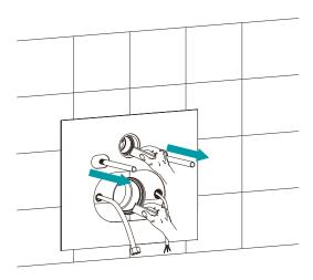
Stecken Sie die zuvor gesägten Frisch- und Abwasserrohre in das Vorwandelement. Tragen Sie anschließend erneut etwas Schmiermittel auf die Gummidichtungen auf.
