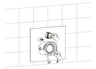
Schieben Sie die Keramik auf die Keramikaufnahmebolzen und achten Sie dabei auf das korrekte Durchführen der Strom- und Wasserzufuhr.
