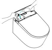
Drücken Sie im unbesetzten Zustand die Tasten ( ) und ( ) gleichzeitig für ca. 4 Sekunden, um den Tank zu entleeren. Sobald der Tank vollständig entleert ist, füllen Sie ca.125 ml MEWATEC Dushlet Cleaner langsam in die dafür vorgesehene Öffnung. Wenn genügend Entkalkungsflüssigkeit eingefüllt wurde, gibt das Dusch-WC 4 Signaltöne von sich.
