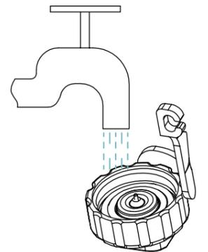
Um den Wasserstop zu reinigen, schrauben Sie die Überwurfmutter ab.
