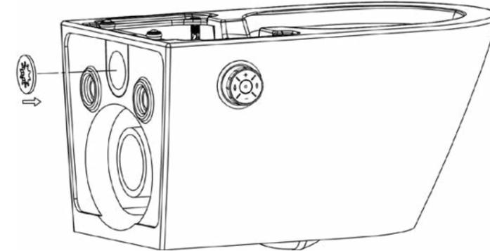
Spülmenge erneut nach oben regulieren, indem Sie einen oder mehrere Zähne aus der Drossel herausschneiden.
