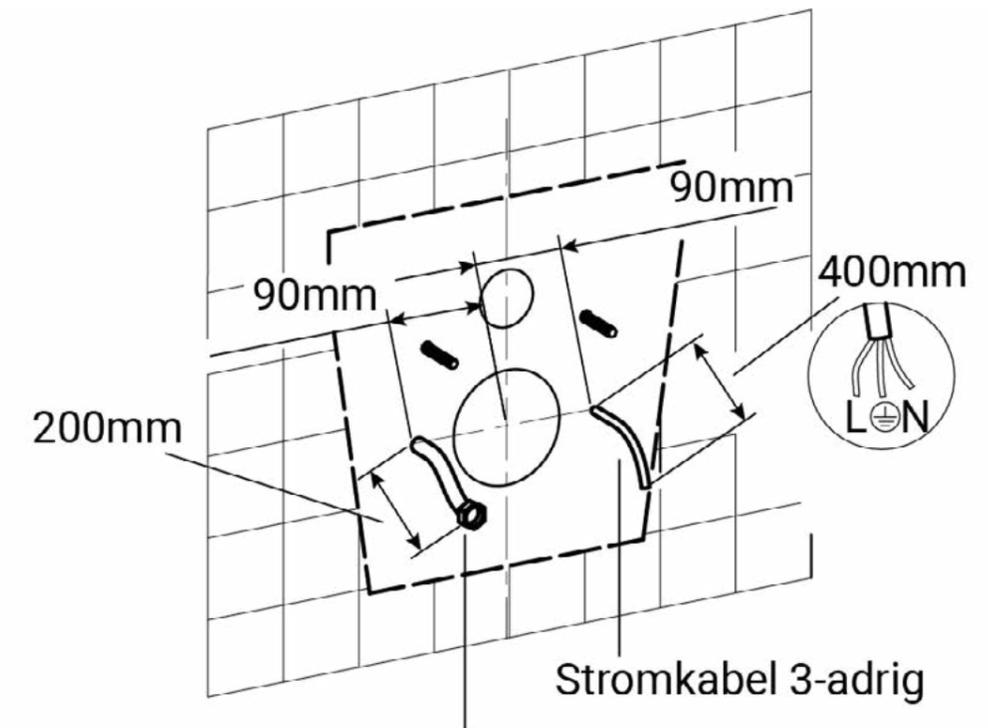
Druckschlauch 120cm oder Standrohr mit 1/2 Zoll Innengewinde
