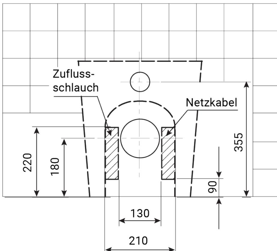
Vergewissern Sie sich vor der Installation, dass sich der Zuflussschlauch und das Netzkabel innerhalb des jeweilig markierten Installations-Bereiches befinden.
