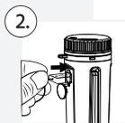
Öffnen Sie die Siliconabdeckung an dem Gerät vorsichtig von oben. Darunter befindet sich eine Micro-USB Schnittstelle.
