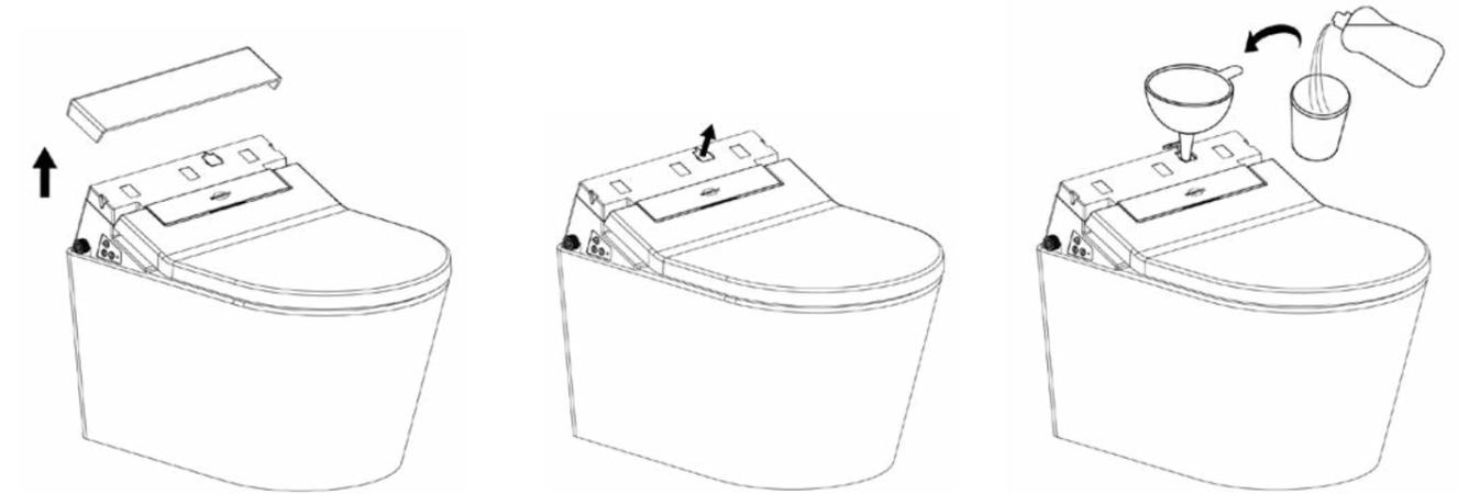
Lösen Sie die hintere Abdeckung und öffnen Sie die Einfüllabdeckung. Füllen Sie nun 50 ml MEWATEC Dushlet Cleaner® mithilfe des Messbechers und Trichters langsam in den Tank. Schließen Sie die Einfüllabdeckung.
