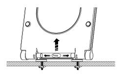
Um den WC-Sitz zu entfernen, drücken Sie gleichzeitig beide Knöpfe am WC-Sitz und heben Sie ihn von den Scharnieren.
