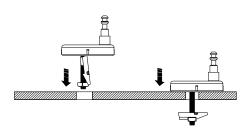
Platzieren Sie die Scharniere der Befestigung in den Deckelaufnahmelöchern der Keramik.
